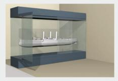
Die linke Frontseite wird geöffnet und mittels kombinierter Scharnier-/Schiebetürmechanik platzsparend nach links gefaltet.
